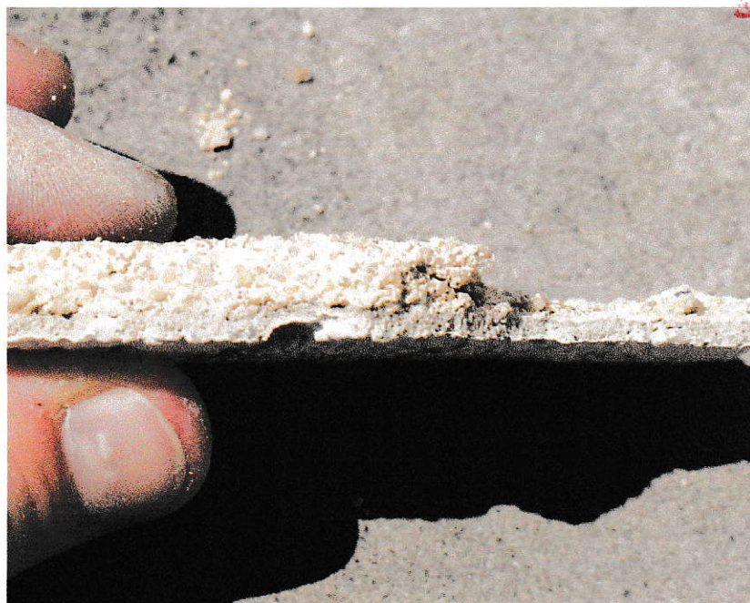
Fot. 28. Próbką pobrana z elewacji południowej – widoczny w przekroju tynk wapienny z kruszywem kwarcowym i szlichta cementowa z powłoką malarską.
